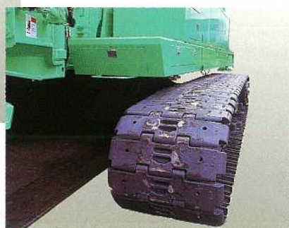
クローラ拡張作業中▶
